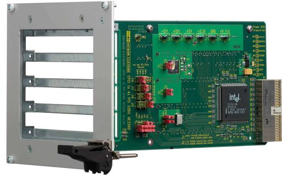
Das moderne **BRIDGE-Design** ermöglicht das Stecken von bis zu 4 Standard PCI® - Karten in einen Compact PCI® Slot.
